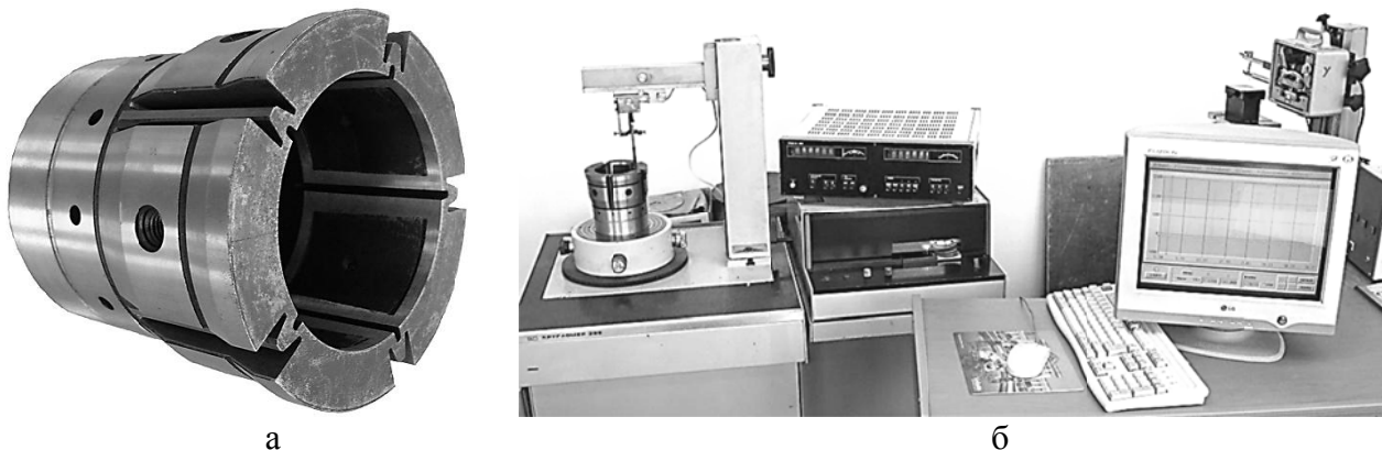
Рис. 1. Загальний вигляд дослідного зразка гідростатичної втулки (а) та вимірювального комплексу (б)
